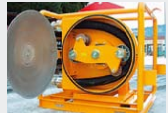
Schlauchpumpe HP-50 mit geöffnetem Pumpendeckel Hose Pump HP-50 with open pump cover
